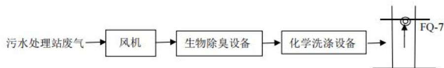
图 4.1.6 污水处理站废气处理工艺流程图
